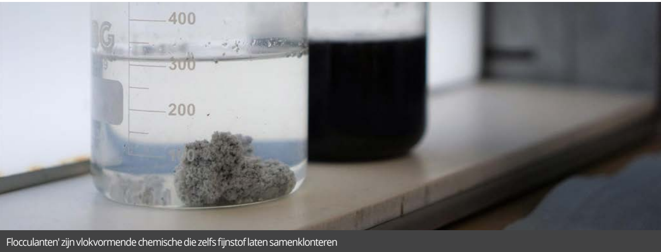
Viek-Machines - Waterzuivering met flocculanten
