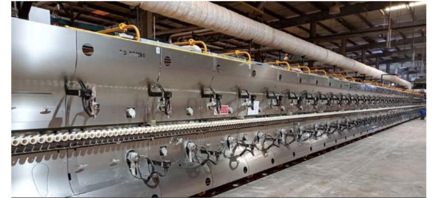
Modena / Alfano - Les fours à haut rendement dotés d'une meilleure isolation et d'un système de récupération de la chaleur réduisent la consommation de combustible dans la production de carreaux céramiques
