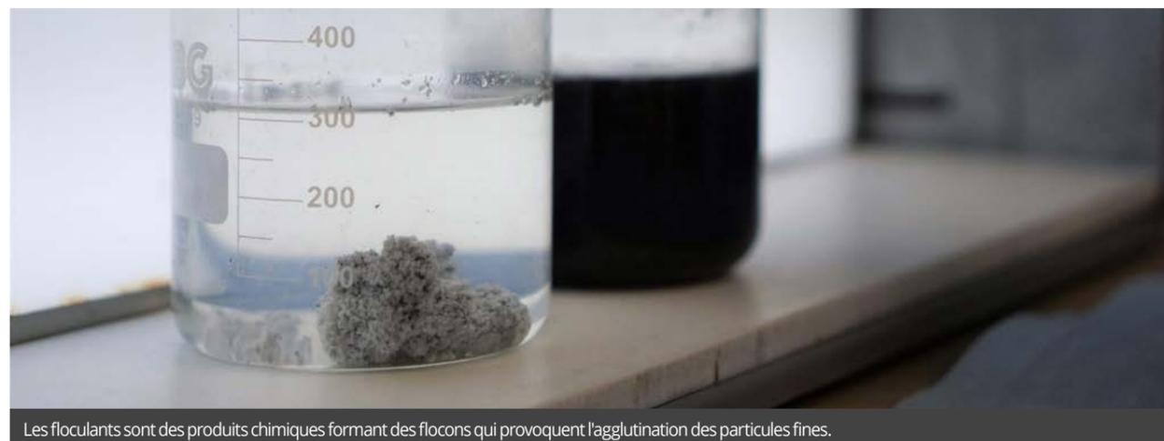
Les floculants sont des produits chimiques formant des flocons qui provoquent l'agglutination des particules fines.
