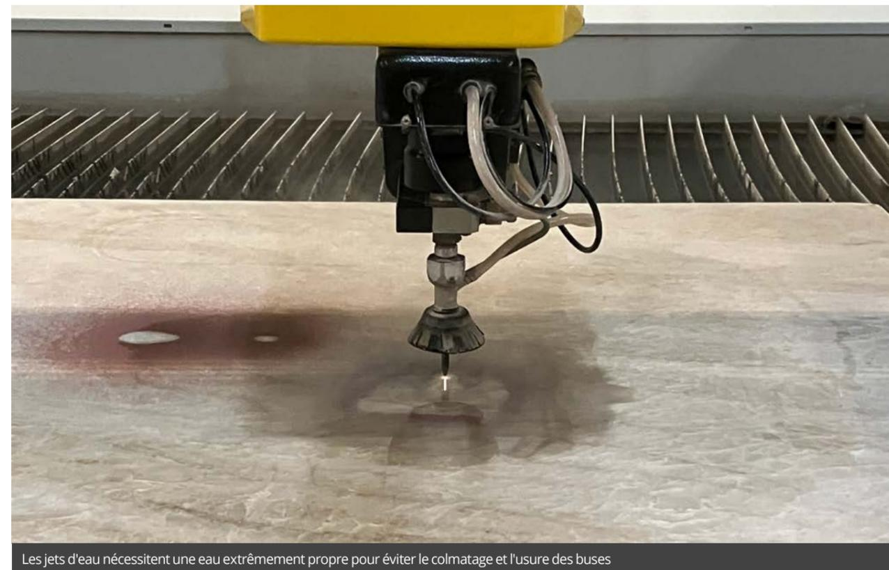
Les jets d'eau nécessitent une eau extrêmement propre pour éviter le colmatage et l'usure des buses
