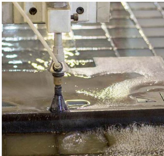
© Techni - Een CNC-brugzaag gebruikt een roterend zaagblad, een waterjet werkt met een waterstraal onder extreem hoge druk
