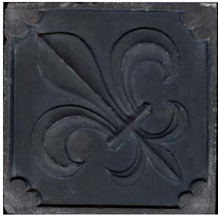
Laagrelieftegels worden doorgaans geperst, hoogrelieftegels dienen geëstampeerd of gegoten te worden. Dit gebeurt bij het eerste type meestal met metalen mallen waaruit het te bekomen reliëf is weggehaald – zoals te zien is bij voorbeeld van Gilliot & Cie - en bij de hoogrelieftegels door middel van gipsmallen, zoals het voorbeeld van de firma Escoyez duidelijk maakt (Collectie M. Baeck).
