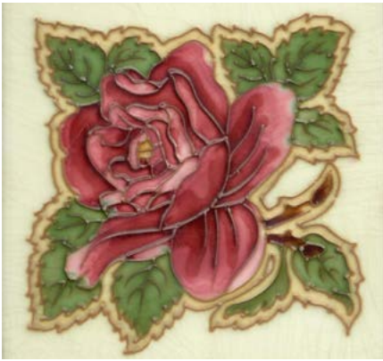
Tegels met handmatig opgelegd lijnreliëf, zoals een belangrijk deel van de productie bij Gilliot & Cie, zijn te onderscheiden van de geperste of gegoten lijnreliëftegels door de karakteristieke verdikkingen of ‘knoopjes’ op plaatsen waar twee of meer kleidammetjes samen komen (Collectie M. Baeck).
