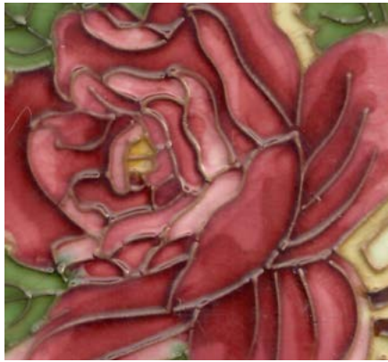
Tegels met handmatig opgelegd lijnreliëf, zoals een belangrijk deel van de productie bij Gilliot & Cie, zijn te onderscheiden van de geperste of gegoten lijnreliëftegels door de karakteristieke verdikkingen of ‘knoopjes’ op plaatsen waar twee of meer kleidammetjes samen komen (Collectie M. Baeck).
