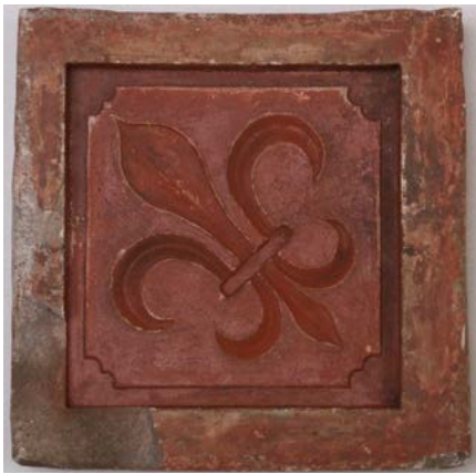
Laagrelieftegels worden doorgaans geperst, hoogrelieftegels dienen geëstampeerd of gegoten te worden. Dit gebeurt bij het eerste type meestal met metalen mallen waaruit het te bekomen reliëf is weggehaald – zoals te zien is bij voorbeeld van Gilliot & Cie - en bij de hoogrelieftegels door middel van gipsmallen, zoals het voorbeeld van de firma Escoyez duidelijk maakt (Collectie M. Baeck).
