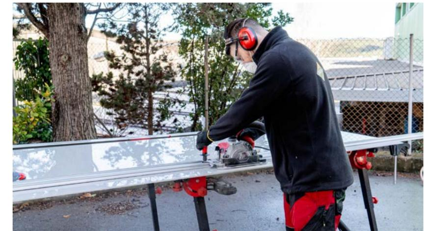
La TC-125 G2 convient à la découpe de carreaux de sol compacts, de grès cérame, de pierre naturelle et de pierre frittée. Elle fonctionne exclusivement sur des rails de guidage et est généralement achetée avec les guides. Le kit complet comprend la scie circulaire, les guides, une lame de scie diamantée, des ventouses de fixation, des pinces, des entretoises et un adaptateur pour aspirateur. La scie est livrée de série avec une lame TCR, mais d'autres lames sont également disponibles.
