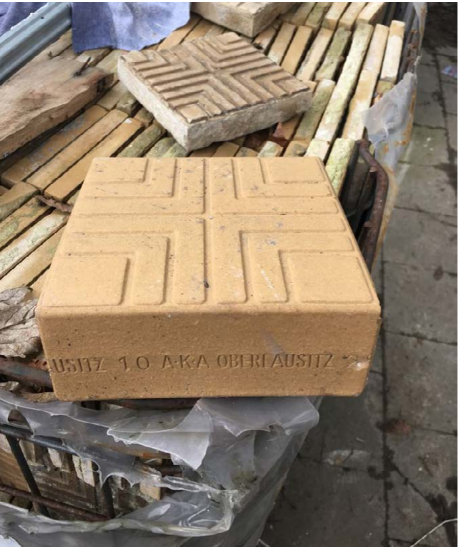
De originele plavuizen op de wandeldijk in Oostende werden vervangen door analoge maar grotere en zwaardere plavuizen die een hogere belasting door het vrachtverkeer voor werken en leveringen allerhande toelaten (foto M. Baeck)
