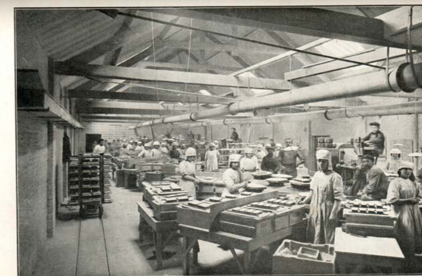
Usine "Carreaux Céramiques" II e division: Pressage des carreaux incrustés.
