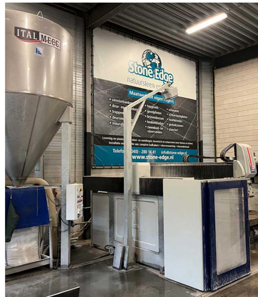
La débiteuse à pont entièrement automatique EmmeDue Discovery 5 Axis Plus. Avec son moteur de 24 CV, elle permet de travailler des épaisseurs jusqu'à 200 millimètres.
